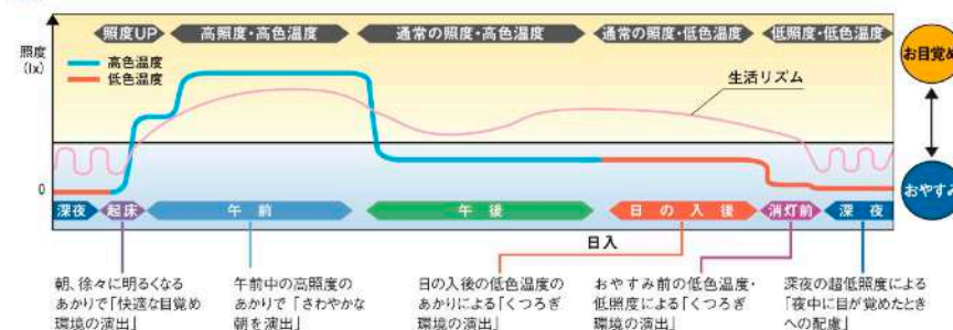
1日の照明制御(照度、色温度)スケジュールの例
